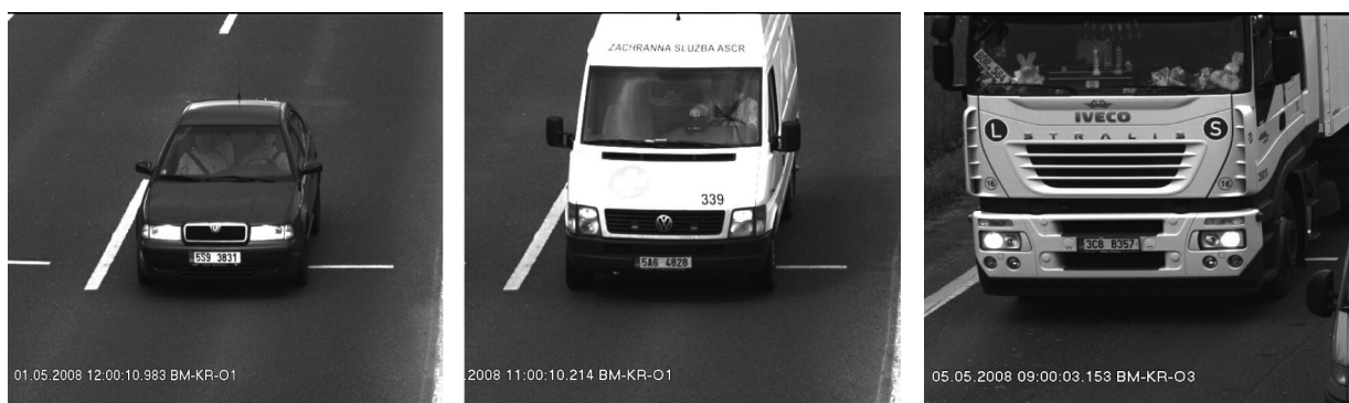
Obr. 9: Ukázka klasifikace vozidel z obrazu do 3 tříd: osobní vozidlo, lehké nákladní vozidlo a těžké nákladní vozidlo.
